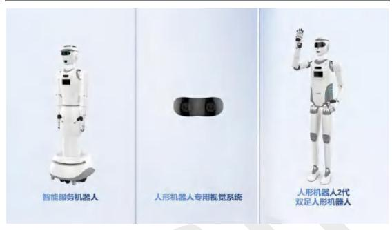
ViHero 创世纪版发布后,伟景机器人秉承"为梦想、为世界打造一款真正的智能机器人"发展理念,继续研发更为复杂的双足机器人,该款机器人具备像人一样通过双足行走,能够根据不同路面状况调整自身各关节的转角,实现在非平整路面或有障碍物等复杂路面上的步态切换,灵活自如地完成躲避障碍物、跨越沟壑、上下楼梯、爬坡等任务。
