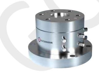
(5)基于 MEMS 原理的关节力矩传感器,无需胶水粘贴,采用硅微熔技术。过载能力、温度灵敏度漂移、长期可靠性、刚性、一致性等方面均表现突出。通过全自动化设备投入,规模化生产,大幅降低传感器的价格,确保人形机器人的每个关节都能用得起。
